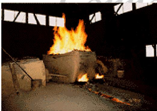
fig.13 : Four Tatar en fonctionnement : flamme au dessus du four, d'après [12].
